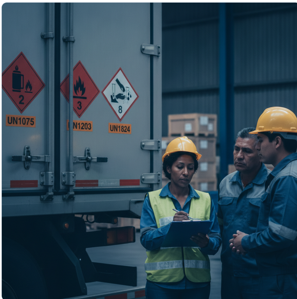
Camión de transporte de mercancías peligrosas con señalización de clases NCh 382, permitiendo identificación rápida del riesgo en caso de emergencia.
