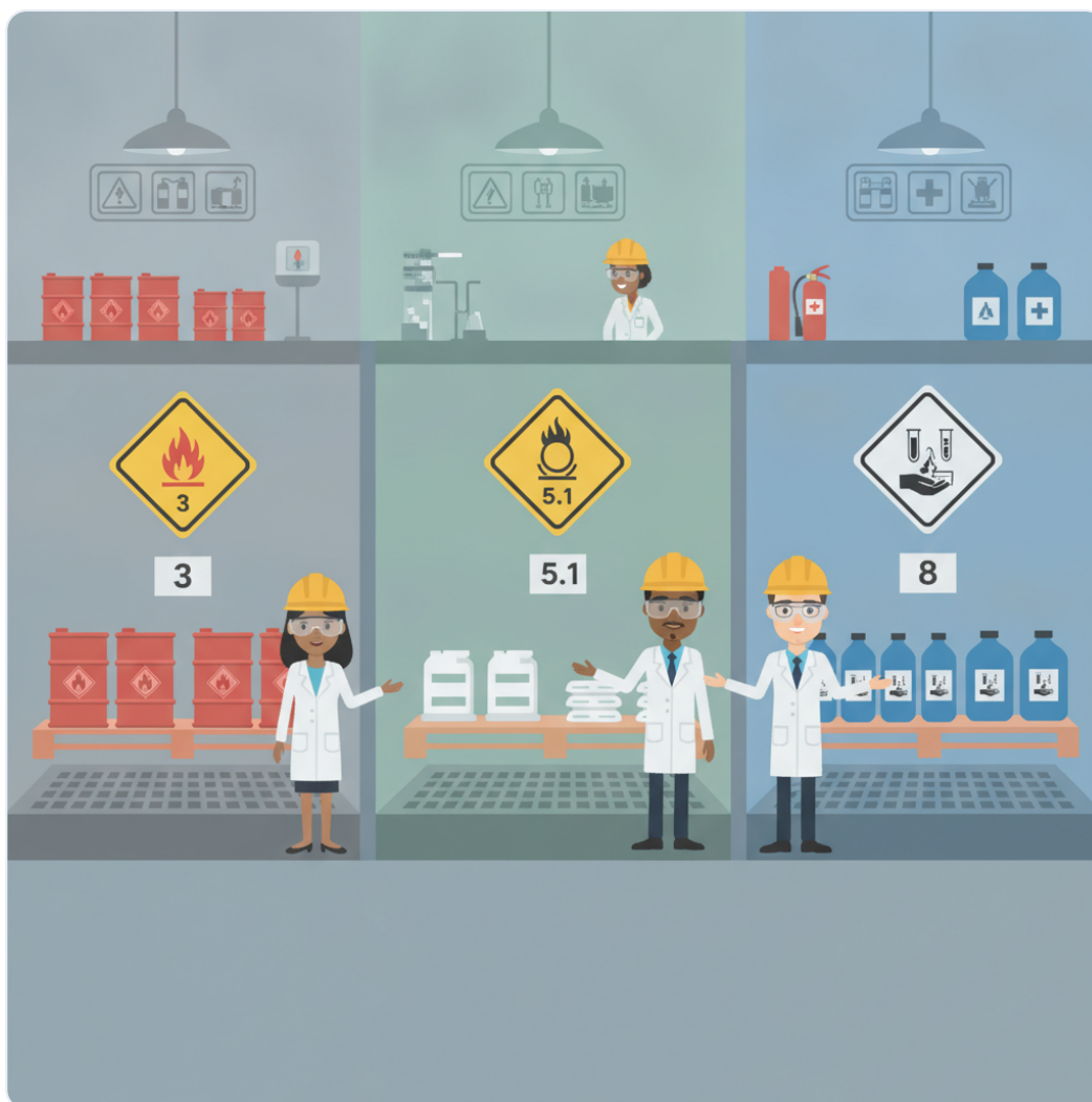
Bodega de sustancias peligrosas con segregación correcta por clases NCh 382: líquidos inflamables (clase 3), corrosivos (clase 8) y combustibles (clase 5.1) en zonas separadas con señalización adecuada.
