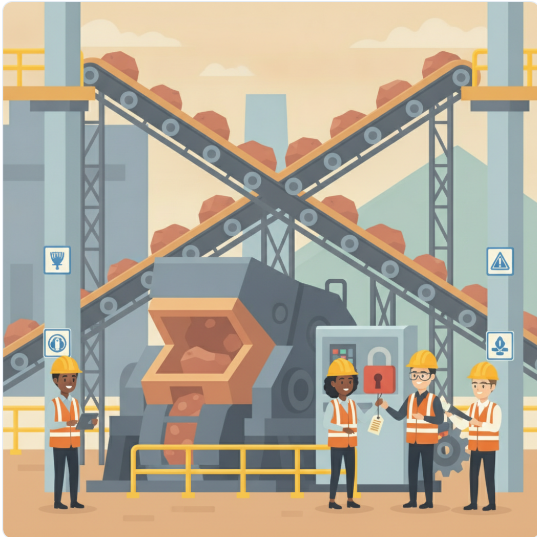
Planta de chancado primario con sistemas de transporte por correa. Observa los puntos críticos de riesgo: chancador, poleas y áreas de inspección donde se aplican procedimientos LOTO.
